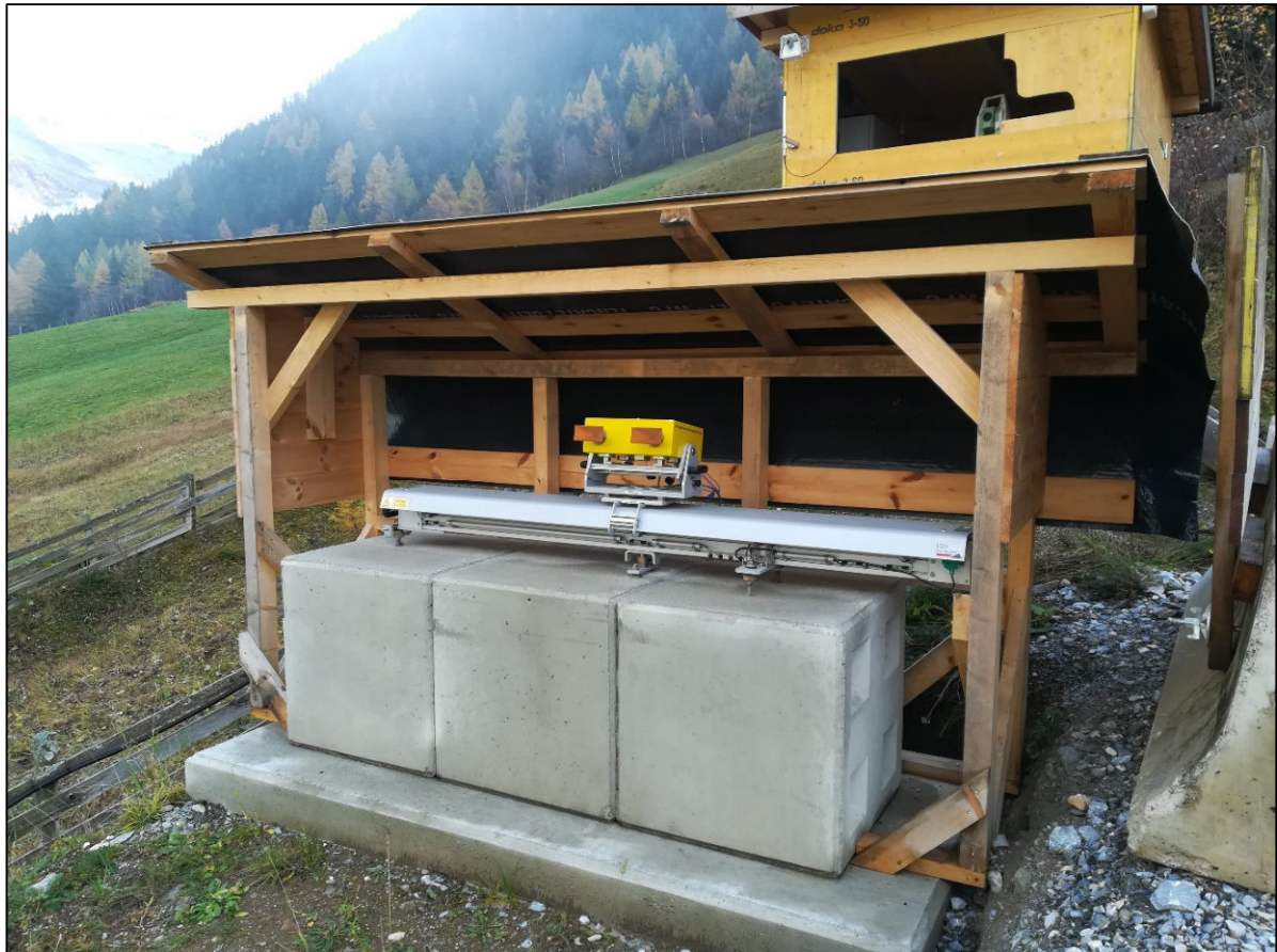
Abbildung 11: Linearverschiebeeinheit und Radarsensor
